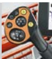
Con la tecla para el reglaje de la altura en el mando multifuncional, se activa fácilmente el automatismo del mecanismo de corte.
