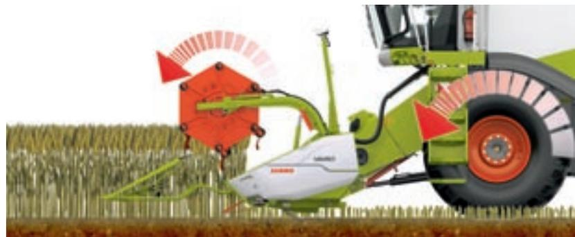
Sistema automático del mecanismo de corte
