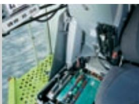
Todas las conexiones electrónicas se juntan en la cabina.
