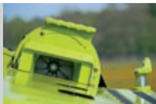
Aspiración de polvo en el canal de alimentación para una libre visibilidad.
